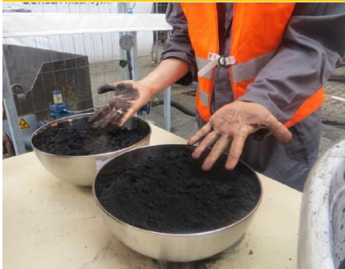
Пример сравнения влажности флотационного концентрата при режимах работы с паром и без
