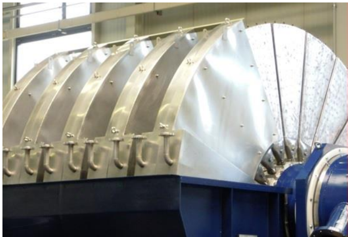
Паровые кожуха на вакуумных фильтрах Vooger
