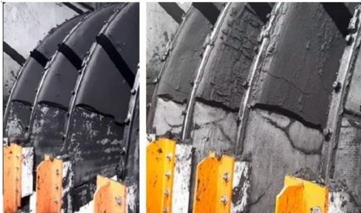
Обезвоженный кек работы вакуумных фильтров Boozer Me8-Tyре на ОФ «Ш. им. С.М. Кирова»
