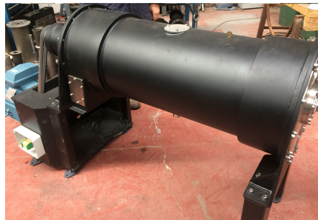
Рисунок 7 Антивибрационная система всей установки.
