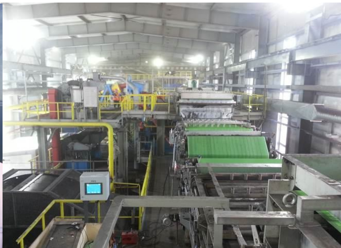
Рисунок 3 – Линия обезвоживания на базе ФП
