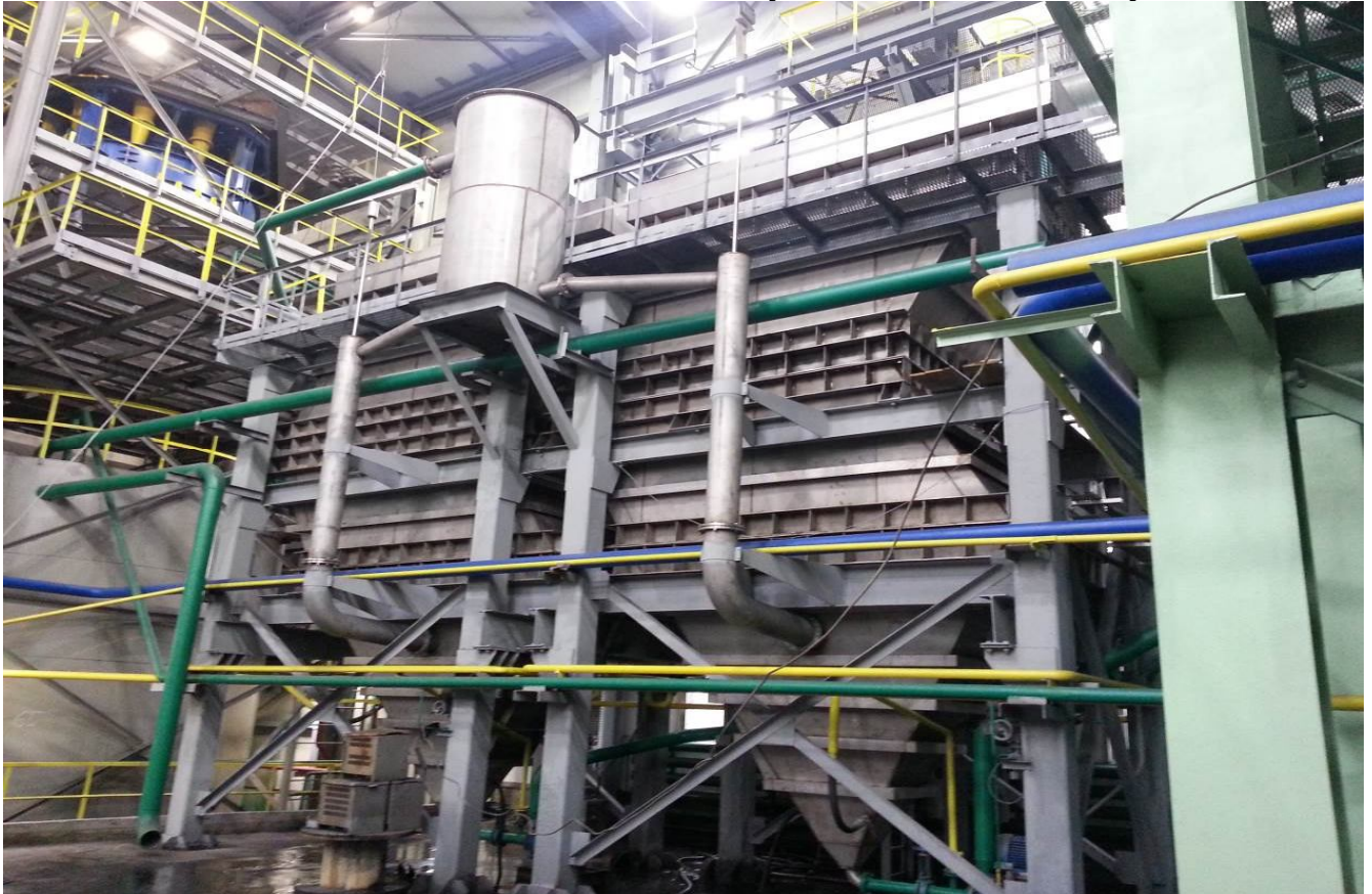
Рисунок 1 – Пластинчатый сгуститель СП-500
